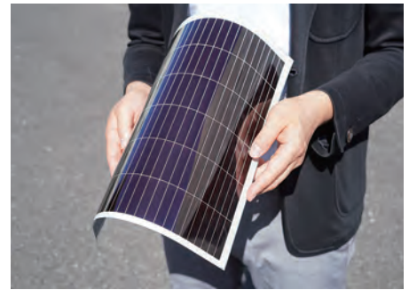
インクジェット印刷によるペロブスカイト太陽電池
