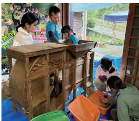
風選作業は、唐箕（とうみ）という機械を使って風の力で小麦とゴミを選別します
